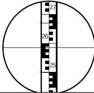
8. Определите расстояние от прибора до рейки
