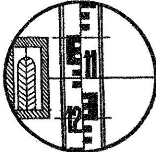
9. Снимите отсчет по вертикальному кругу теодолита
